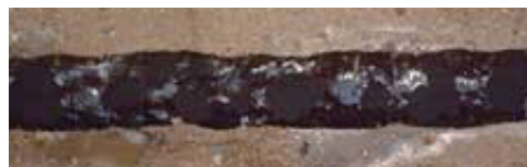
水によって水溶性フィルムが溶け出し水と組成物が反応する
