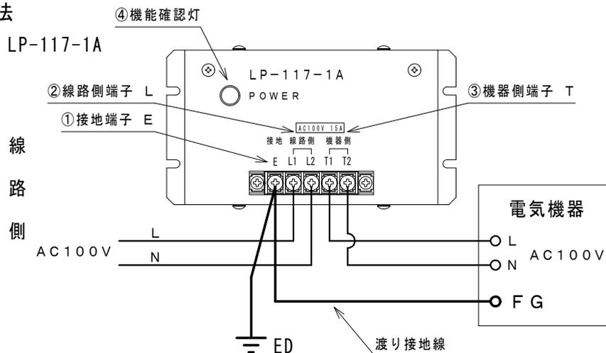
接地線は図のように渡り接地をしてください。また、出来るだけ短く配線し太い線 (5.5mm<sup>2</sup>以上) をご使用ください。
